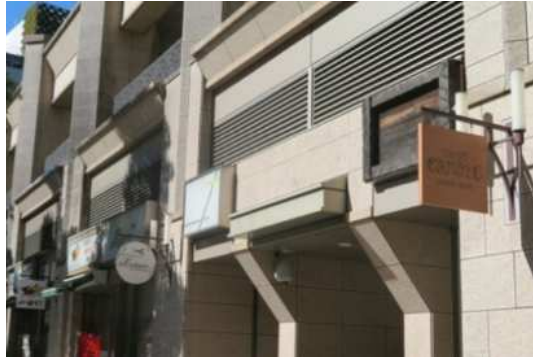
壁面広告物のフレームの形状や、突出広告物の出幅を統一し、低層部のテナント店舗群でまち並みを演出しています。
