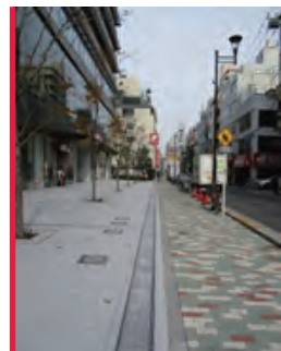
歩道状空地の整備イメージ …建築物の壁面後退により、既存の歩道と一体的に整備した歩道状空地
