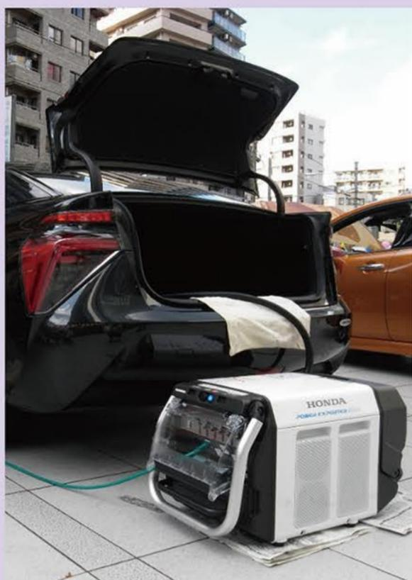
区では、水素で走る燃料電池自動車(FCV)に接続し、自動車の電気を家庭用電源に変換して電力を取り出す外部給電器を導入しました。
