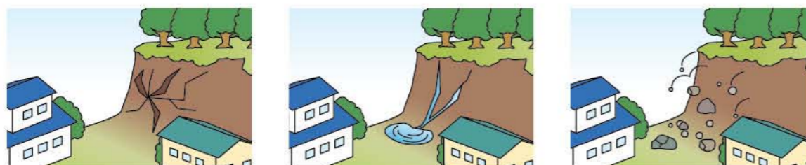
斜面にひび割れができます。 わき水の量が増えます。 がけに亀裂が入ります。 がけから石が落ちてきます。
