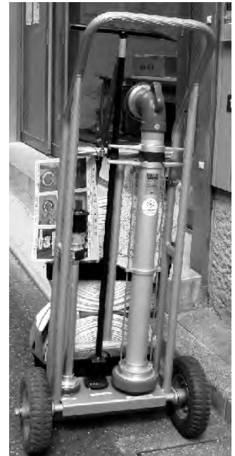
写真：スタンドパイプ、ホース等一式
